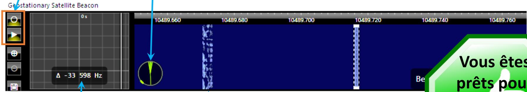
Ecart entre la fréquence reçue du LNB et la fréquence réelle
